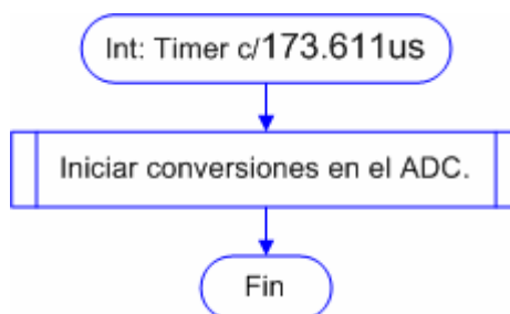
Figura 4.4.- Diagrama de flujo de la interrupción “TimerInt” para indicar los inicios de conversión del ADC.
